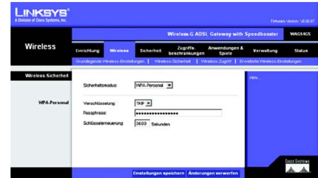
Abbildung 6-16: Wireless Security Sicherheit im Wireless-Netzwerkbetrieb – WPA-Personal
